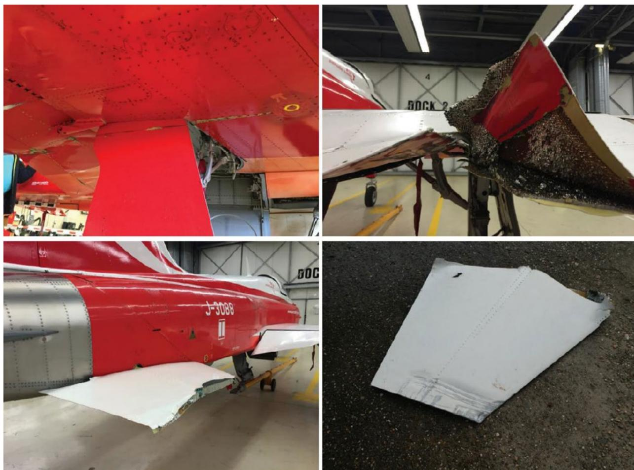
Abbildung 7: Schaden Flugzeug Nummer 2 - Unterseite rechter Flügel (oben links); rechte Hinterkantenklappe (oben rechts); rechtes Höhenleitwerk (unten links); Gefundener Teil des rechten Höhenleitwerks (unten rechts). (Quelle: Dutch Safety Board)
