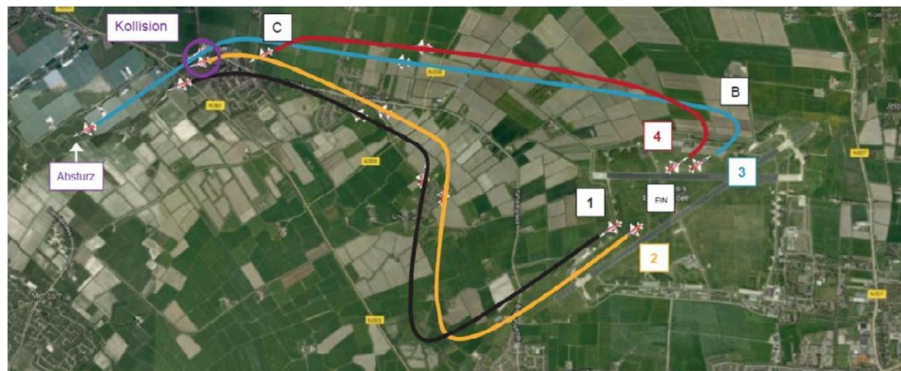
Abbildung 1: Von den vier Flugzeugen der Formation geflogene Spuren und der Ort der Kollision. Die schwarze Linie stellt die Strecke von Nummer 1 dar, die gelbe Linie ist Nummer 2, die blaue Linie ist Nummer 3 und die rote Linie ist Nummer 4. (Quelle: Dutch Safety Board)
